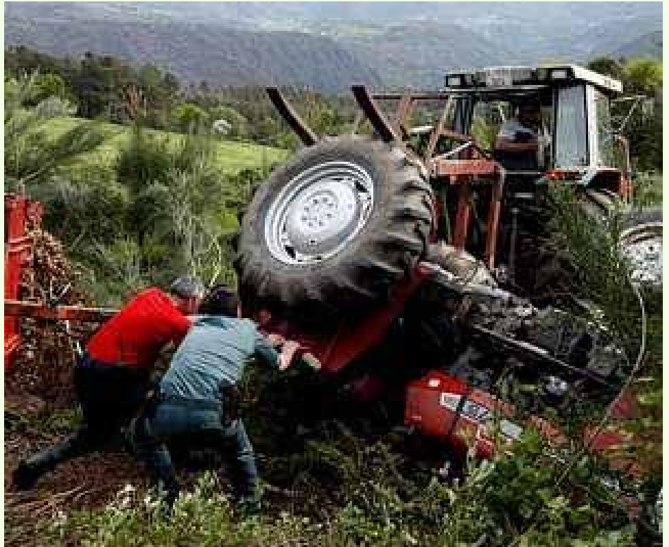
Accidente de tractor Massey Ferguson desprovisto de barra antivuelco
