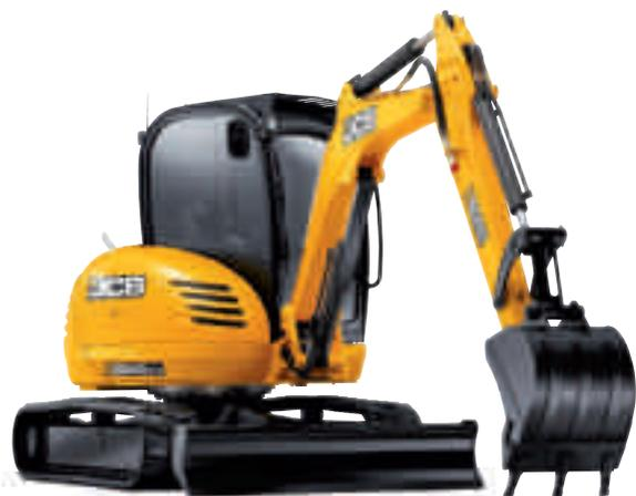
Los modelos 8040 ZTS, 8045 ZTS y 8050 RTS/ZTS incorporan un motor de 34kW (46hp), lo que hace de ellas máquinas muy potentes para este tipo de excavadora.
