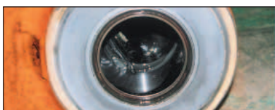
Pulverización térmica WC
