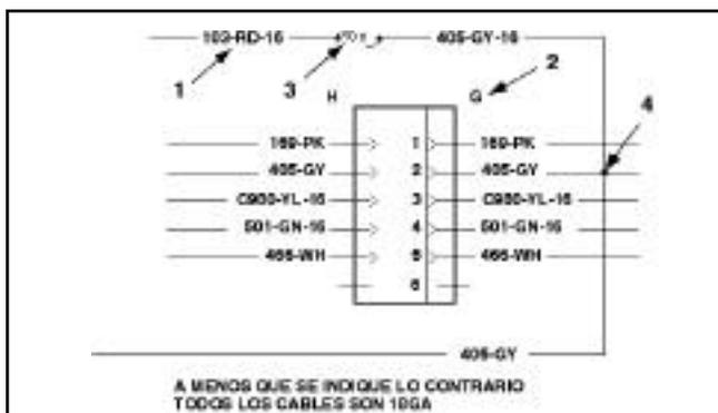
**Ilustración 1.** Muestra de los símbolos del diagrama de formato anterior: (1) Etiqueta del cable. (2) Etiqueta del conector. (3) Etiqueta de los componentes. (4) Símbolo anterior de empalme.
