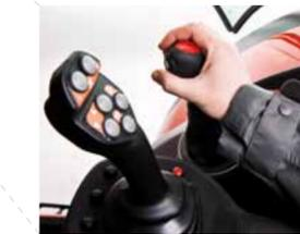
Die optionale **Joystick-Armlehne** dient zur Bedienung von Frontlader, Hydraulik und Power-Shuttle. Über Mikroschalter kann zwischen den verschiedenen Funktionen gewechselt werden.
