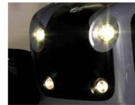
Der **GEOTRAC 124** ist serienmäßig mit leuchtstarken **Ellipsoid-Scheinwerfern** ausgestattet. Die 4 Dachscheinwerfer sorgen für zuverlässige Ausleuchtung, wenn Frontgeräte angehängt werden.
