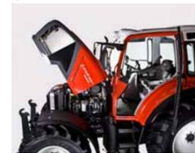
Die **einteilige Motorhaube** ist mit Gasdruckzylindern bequem zu öffnen. Die Kühler können durch ihre durchdachte Anordnung komfortabel gereinigt werden, ohne geklappt werden zu müssen.
