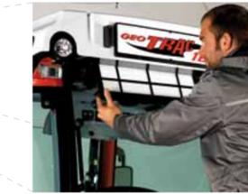
Durch die optionale **Klimaautomatik** kann die Raumtemperatur komfortabel geregelt werden. Das seitliche Ablagefach wird mitgekühlt. Auch der Filter ist mit Hilfe der Heckhydraulik bequem zu erreichen.
