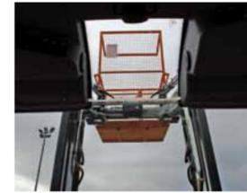
Mit der innovativen **Frontlader-Freichtscheibe** erreicht der **GEOTRAC 124** ein unvergleichlich großes Sichtfeld bei Frontladerarbeiten. Eine **integrierte Blende** schützt vor direkter Sonneneinstrahlung.
