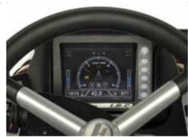
Auf dem **Lindner-I.B.C.-Monitor** sind alle Fahrzeuginformationen übersichtlich dargestellt. Der durch reflexionsarmes Echtglas geschützte Spezialbildschirm ist sogar bei direkter Sonneneinstrahlung gut ablesbar. Über die beleuchteten Funktionstasten und das Drehrad ist die Navigation im Bordmenü einfach und intuitiv verständlich.
