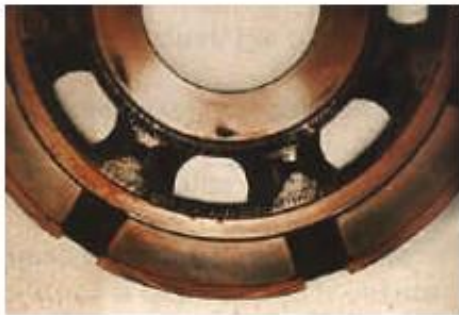
Corrosión de Cavitation en el plato del puerto de una bomba del pistón axial
