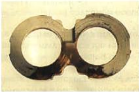
ejemplos de averías causadas por cavitación
