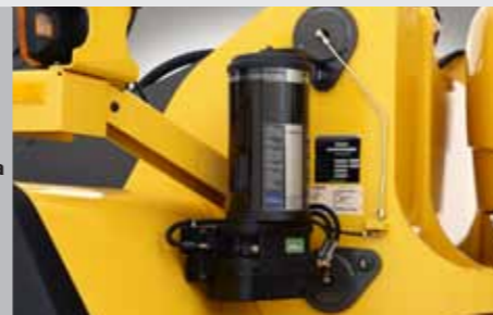
Sistema de lubricación automática
