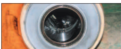
Pulverización térmica WC
