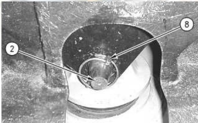
6. Quite el pasador de retención (8) y el pasador (2) en la parte trasera de la cabina. El pasador (2) se debe sacar hacia la parte delantera de la máquina.
