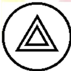
**Peligro** - Empuje la parte superior del interruptor para activar las luces intermitentes de peligro. Empuje la parte inferior del interruptor para desactivar las luces
