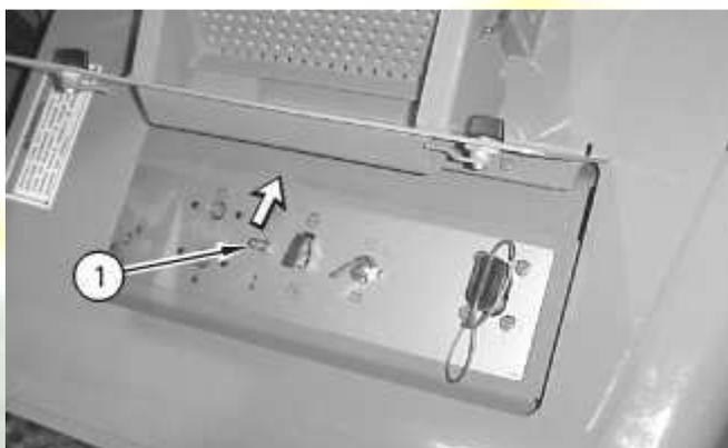
2. Tire del control (interruptor) (1) hacia afuera. Sujete el interruptor en esta posición. Mueva el interruptor hacia arriba para levantar el capó.
