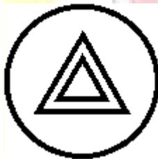
**Peligro** - Oprima la parte superior del interruptor para encender las luces intermitente de peligro. Oprima la parte inferior del interruptor para apagar las luces intermitentes de peligro.
