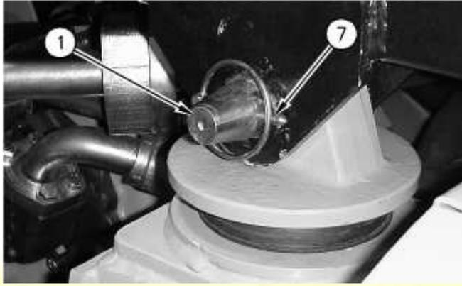
5. Quite el pasador de retención (7) y el pasador (1) en la parte delantera de la cabina. El pasador (1) se debe sacar hacia la parte trasera de la máquina.
