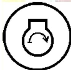
**ARRANQUE** - Para arrancar el motor, gire el interruptor de arranque hacia la derecha, hasta la posición de ARRANCAR. Cuando se suelte la llave del interruptor de arranque, ésta regresará a la posición CONECTADA.
