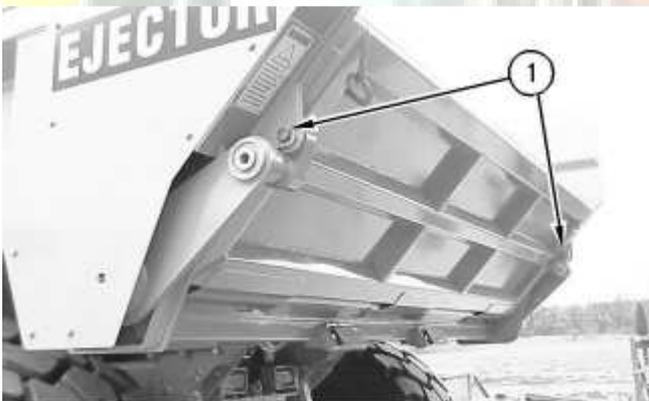
La máquina está equipada con una compuerta de cola. Cuando se cierra la compuerta de cola, la carga se mantendrá dentro de la caja.
