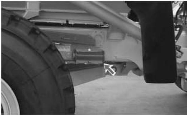
Traba del bastidor de la dirección en la posición guardada
