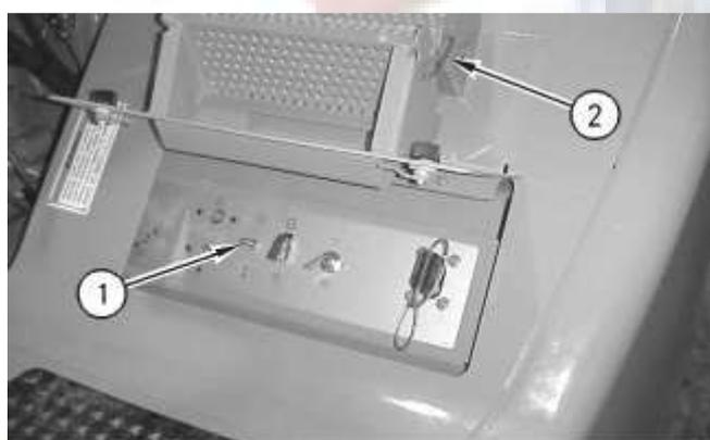
1. Gire los dos pestillos de la tapa hacia la izquierda para destrabar la tapa. Abra la tapa para lograr acceso al control (interruptor) (1). El soporte (2) debe sujetar la tapa en posición abierta.
