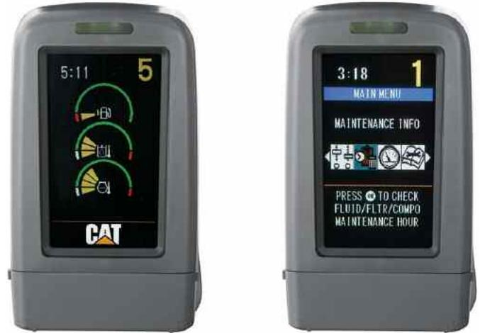
**Monitor.** El monitor consiste en una pantalla de cristal líquido a color que le ofrece información vital acerca del funcionamiento, el rendimiento y las alertas, todo ello con un formato sencillo y fácil de utilizar.
