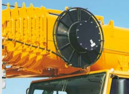
Enrollador de mangueras para el cilindro hidráulico
