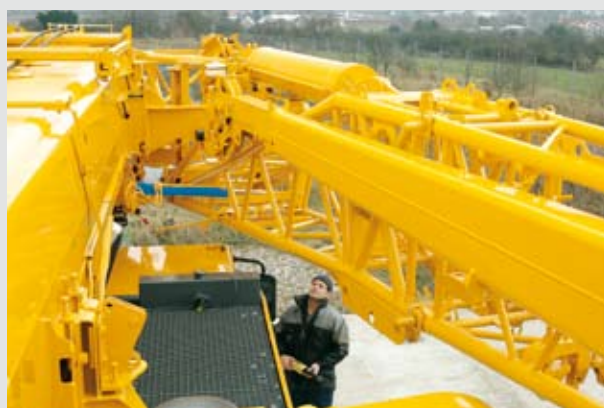
Ayuda hidráulica para el montaje del plumín
