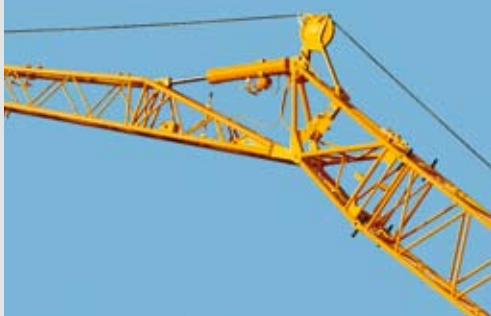
Plumín con angulación hidráulica (0°-40°)
