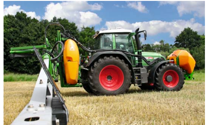
Der Fronttank dient sowohl der Vergrößerung des Tankvolumens als auch als Frontgewicht.
