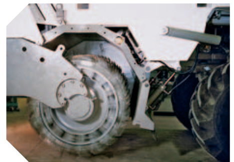
La barra quebrantadora granula firmes de asfalto ▲
