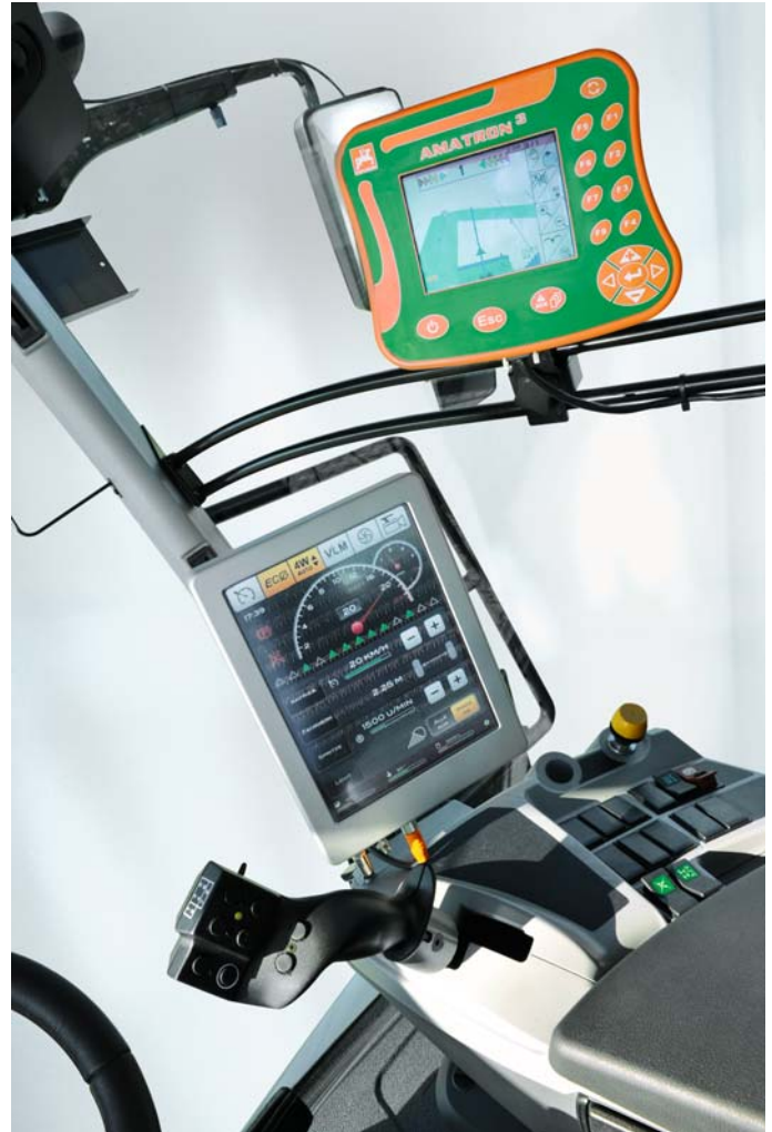
Multifunktionsgriff AMADRIVE für Fahrzeugfunktionen AMATRON 3 für Pflanzenschutzfunktionen
