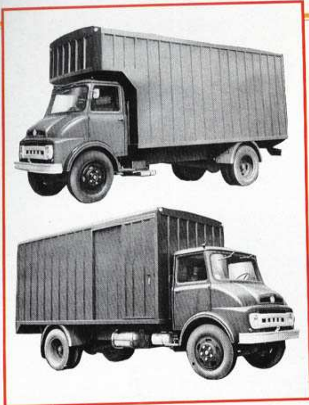
CARROZADOS PARA CUALQUIER NECESIDAD Diferentes aspectos de los carrozados «capitones», muy utilizados por los populares guardamuebles y agencias de mudanzas.
