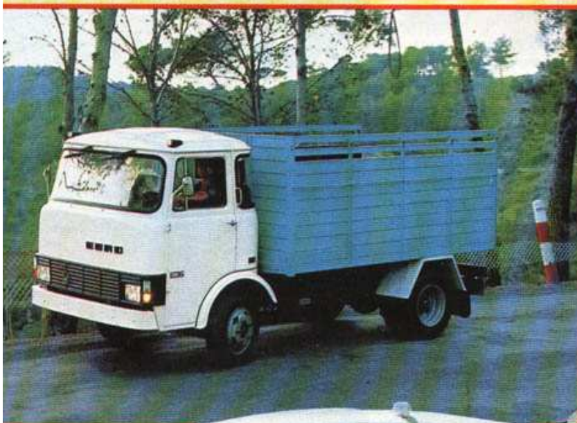
Los camiones de la Serie E incorporaban ya la cabina abatible que facilitaba de forma notable las tareas de mantenimiento en los vehículos.
