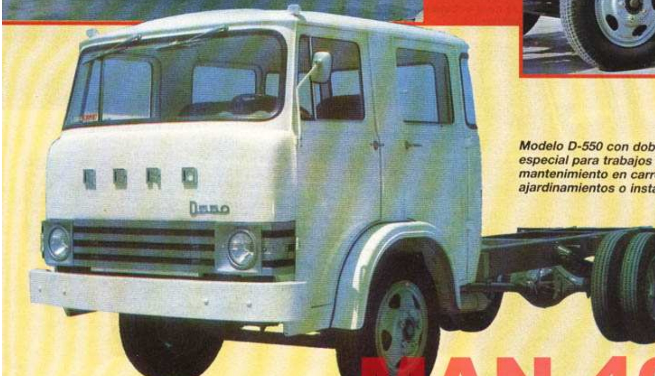
Los camiones de la Serie E incorporaban ya la cabina abatible que facilitaba de forma notable las tareas de mantenimiento en los vehículos.
