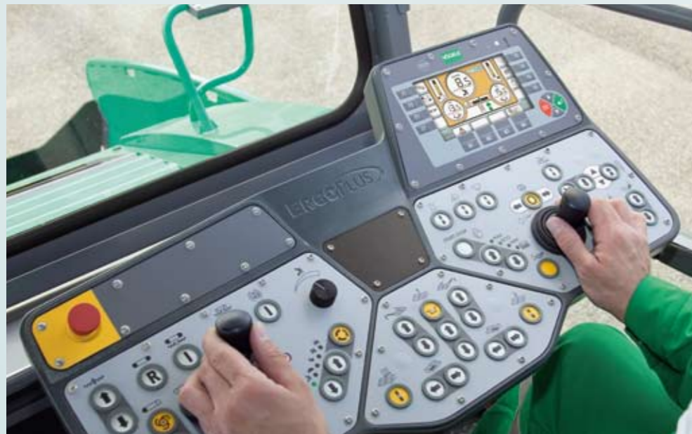
La consola de mando del operario ErgoPlus®
