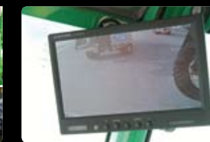
Caméra vidéo avec moniteur pour vision arrière du bras Cámara de vídeo con monitor para visual trasera del brazo
