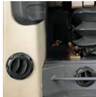
La cabina presurizada y climatizada es estándar. Los registros orientables estilo automóvil mantienen los cristales desempañados y el interior confortable.
