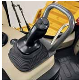
La palanca de control de diseño ergonómico proporciona control intuitivo de la dirección, el sentido de marcha y la velocidad de propulsión. Además, por tener un retén no requiere atención constante, y emplea un interruptor de velocidad de propulsión accionado con un dedo.
