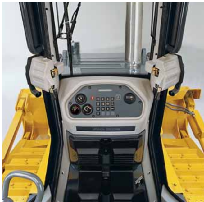
Una amplia superficie de cristal y la exclusiva ROPS de cuatro postes proporcionan una vista imponente inigualada de la hoja, el desgarrador y el entorno.
