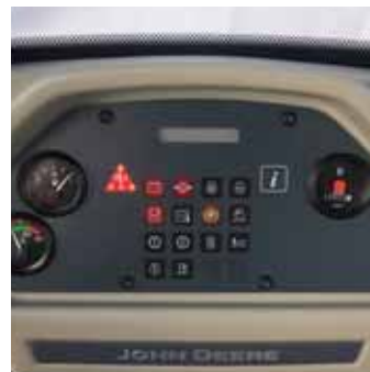
El monitor mejorado está montado en la parte delantera, donde es más fácil de ver mientras se concentra en el trabajo en curso. Los medidores, luces de advertencia e iconos grandes de fácil lectura brindan información operativa crítica a simple vista.
