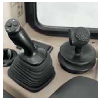
El control piloto y sistema hidráulico con detección de carga permiten el manejo sin esfuerzo, evitan la fatiga y proporcionan una respuesta previsible, independientemente de la carga.
