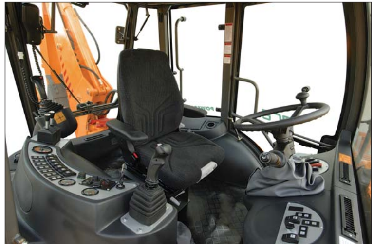
RC5/RC8 - Controles hidráulicos mediante JOYSTICKS que ofrecen mayor precisión y suavidad de movimientos (RC5: bomba de caudal variable - RC8: bomba de caudal fijo)
