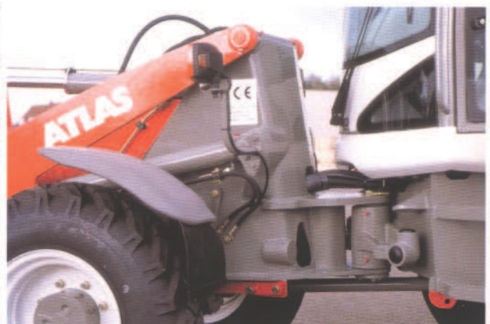
Knickpendelgelenk Gute Geländegängigkeit, hohe Nutzlasten durch tief liegenden Schwerpunkt. Centre-pivot steering Low centre of gravity for good off-the-road manoeuvrability and high payloads. Articulation pendulaire Bonne aptitude tous-terrains, charge utiles élevées grâce au centre de gravité bas.
