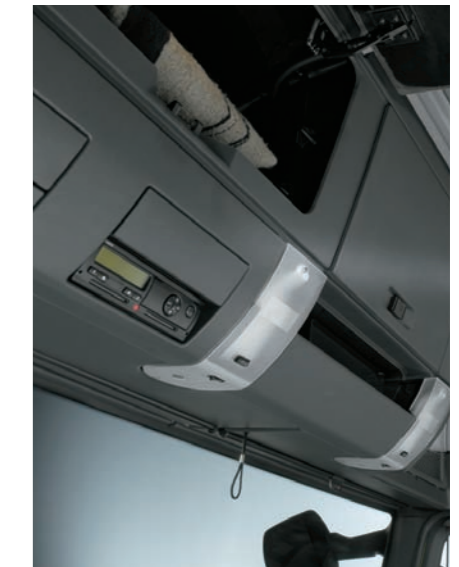
Cofre sobre el limpiaparabrisas y trampilla del techo solar eléctrica en la cabina LX.
