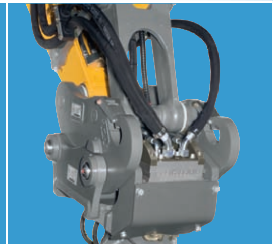
Unido mecánica e hidráulicamente al equipo
